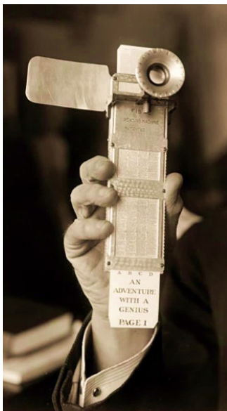
Fig. 27: Bradley Fiske, dispositivo de lectura patentado a principios de la década de 1920. Fuente: Mariano Ramis, "Máquina de lectura Fiske" en Proyecto IDIS . https://proyectoidis.org/maquina-de-lectura-fiske/
